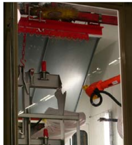
Робот обдувочной очистки в действии
